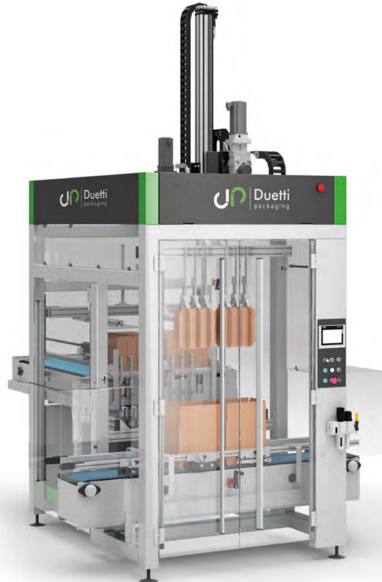
INSERTADOR DE SEPARADORES es una máquina automática diseñada y concebida para la apertura e inserción vertical de separadores en forma de colmena preformados para la separación de productos de cartón americano. Una amplia gama de separadores en colmena estándar, autoportantes y dimensionales en diversas configuraciones.
